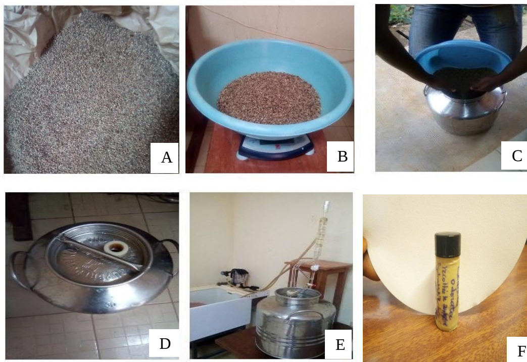
Figure 13 : Extraction de l'huile essentielle des graines de Piper nigrum .
