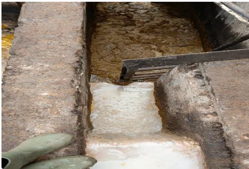
Fig. 13. Déshuilage à l'aide d'un recaleur
