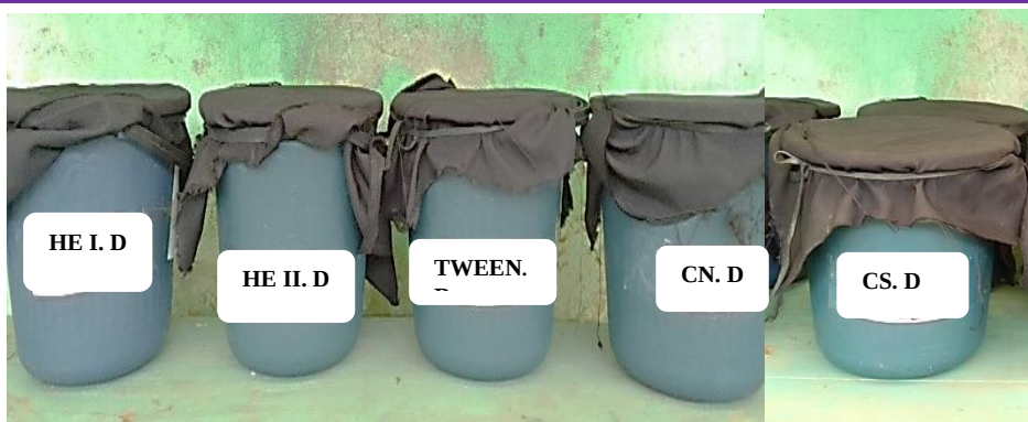
Photographie 8: Dispositif expérimental du test de toxicité par contact aux poissons fumés des huiles essentielles de la citronnelle sur le poisson fumé contre les N. rufipes et D. maculatus (Memadji, 2023).
