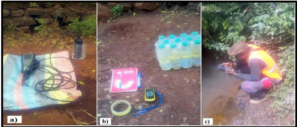
Figure 6: a) un multi paramètre YSI ; b) bouteilles plastique, GPS gramin, marqueur, stylo, cahier de terrain et ruban adhésif ; c) mesure in situ des paramètres physiques
