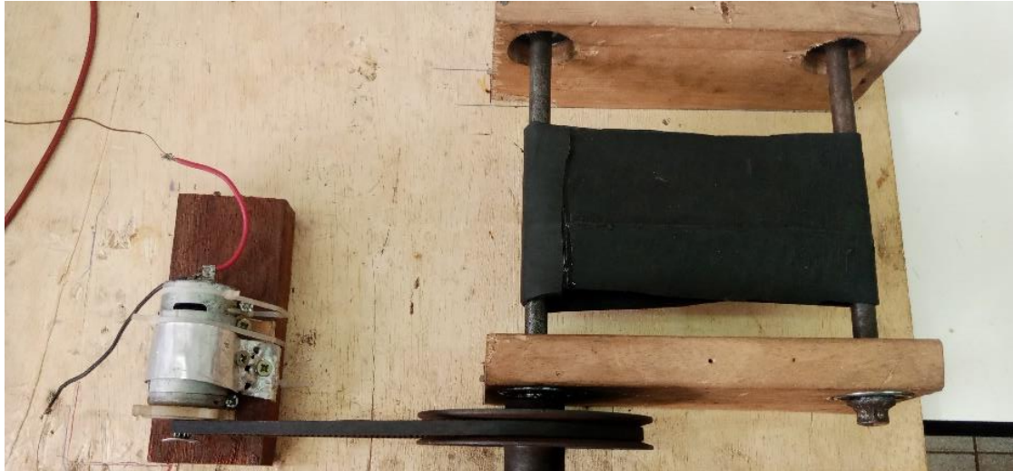
Figure 8: Dispositif expérimental du tapis roulant pour les activités de transport
