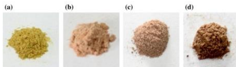
Fig1.15 Couleurs de : (a) Znq 2 @CTA-saponite, (b) Znq 2 CTA@saponite, (c) Znq 2 @CTA-montmorillonite et (d) Znq 2 CTA@montmorillonite
