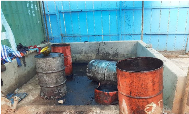
Pollution du sol par le déversement et exposition à l'aire libre des futs contenant les hydrocarbures
