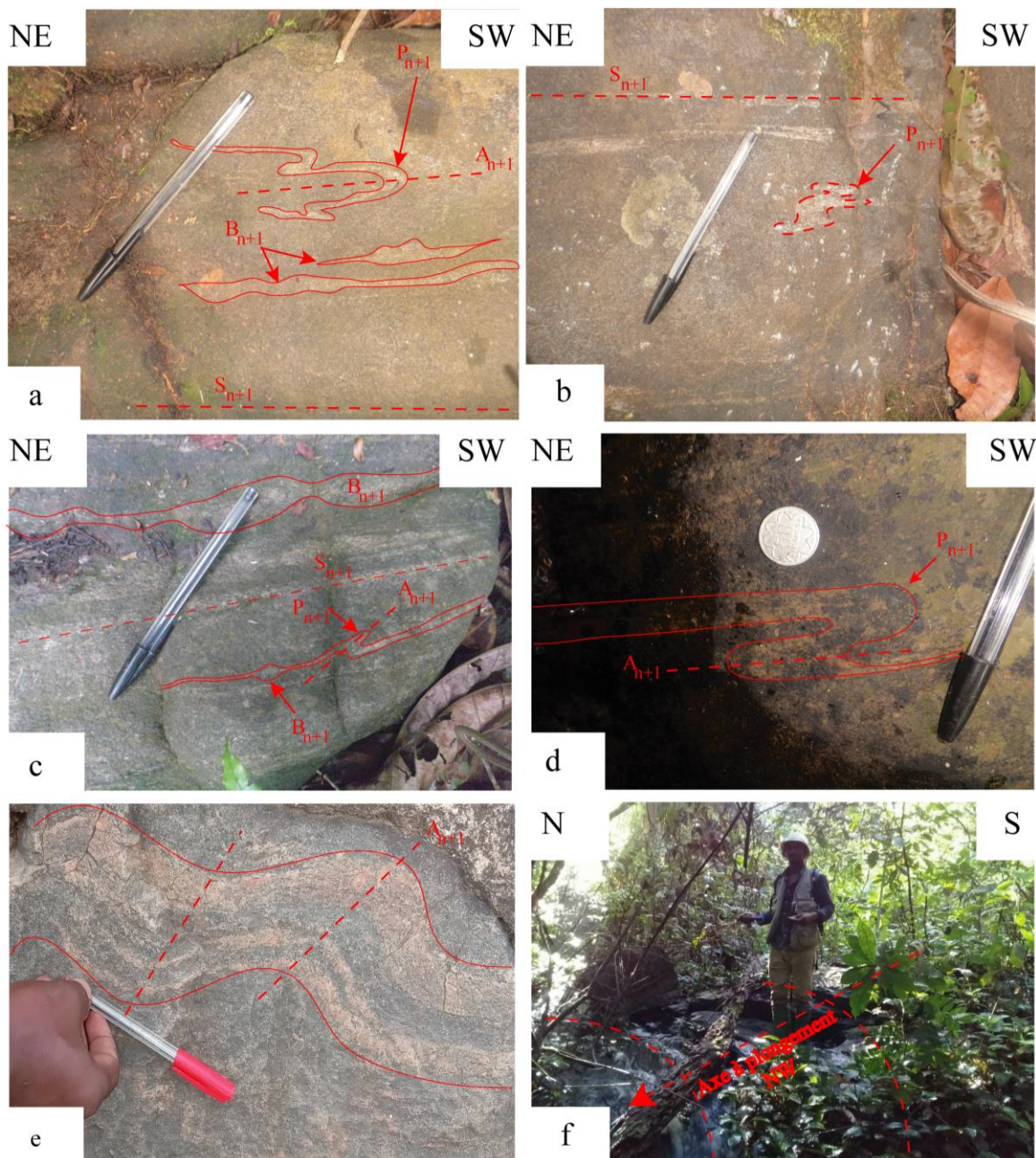
Figure 30. Photographies illustrant les principales structures géologiques de la zone de Kopongo : (a) Gneiss à biotite et amphibole affecté par des plis dissymétriques intrafoliaux P_{n+1} à axe ENE-WSW, parallèle aux boudins B_{n+1} et à la foliation S_{n+1} . (b) Gneiss à hypersthène affecté par un pli ptygmatique intrafolial P_{n+1} . (c) Gneiss à hypersthène développant un pli isoclinal intrafolial P_{n+1} , des boudins B_{n+1} et une foliation S_{n+1} . (d) Pli isoclinal intrafolial P_{n+1} affectant les gneiss à hypersthène. (e) Pli ouvert intrafolial P_{n+1} affectant les gneiss à biotite et amphibole. (f) Pli ouvert P_{n+2} à axe NW-SE, formations ferrifères à magnétite, pyroxènes et hornblendes.
