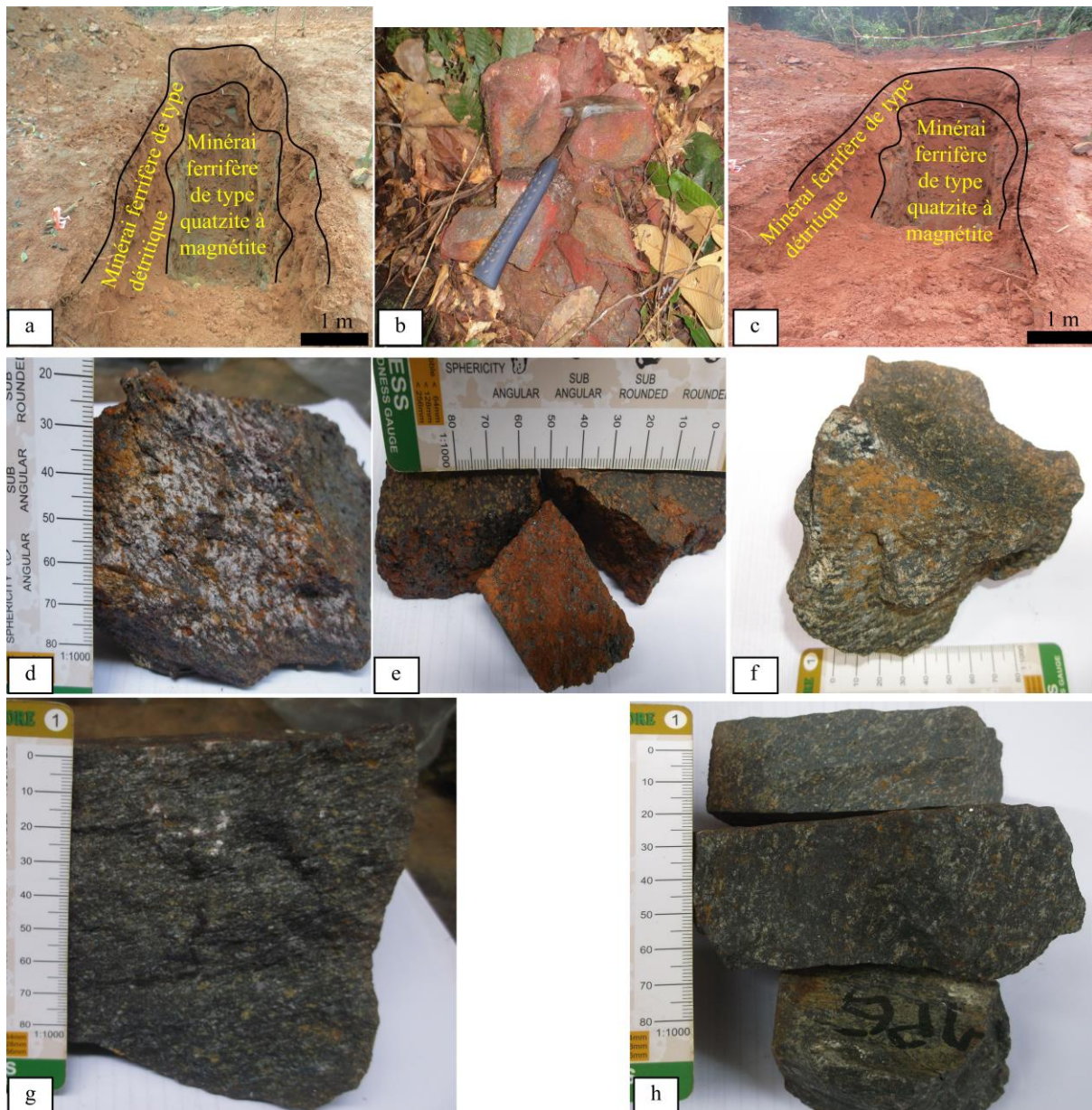
Figure 56. Photos montrant la minéralisation ferrifère de type : (a) Détritique et quartzite à magnétite. (b) Quartzite à magnétite. (c) Détritique et quartzite à magnétite. (d) et (e) Hématite et quartz bréchifié. (f) et (g) À magnétite. (h) À magnétite enrichie.
