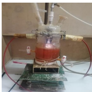
Réacteur plasma lors de la décharge sur la solution d'ORII
