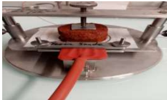
Photo 10 : Mesure des conductivités thermiques des mousses géopolymères.
