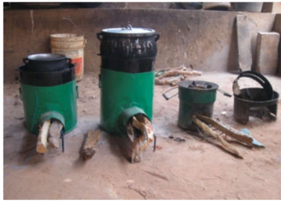
Figure 5 : foyer amélioré métallique
