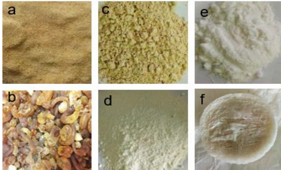
Figure 33 : Matières premières pour formulation des composites (a : Gomme à l'état solide, b : Gomme broyé, c : Bentonite, d : Amidon, e : sodium carbonate, f : ACH( cellulose hydrolysée)
