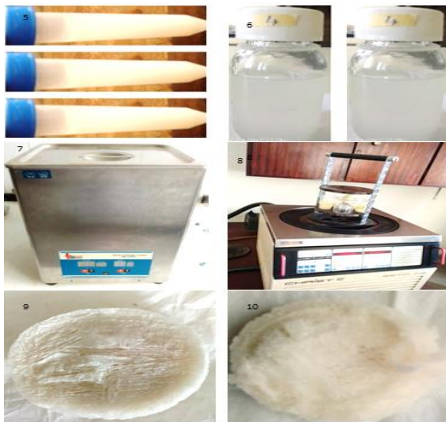
Figure 32 : La présentation de celluloses hydrolysées obtenues après dispersion à l'ultrason et séchées par lyophilisation
