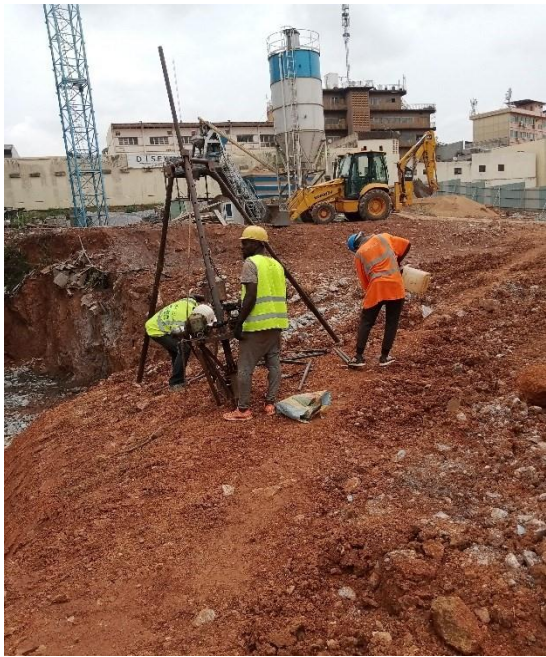
Essai de pénétration dynamique de point
