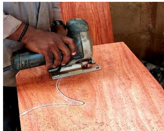
Photo 23 : chantournement avec de la scie sauteuse des gabarits
