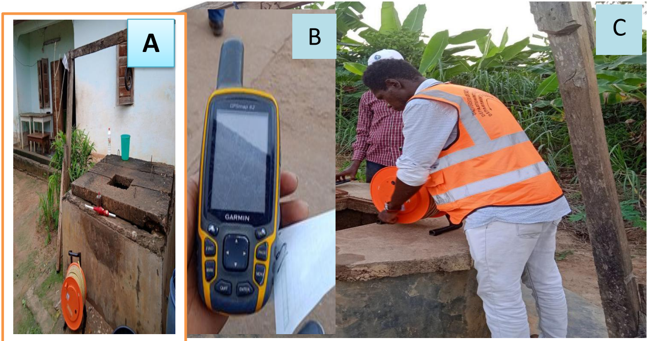
Figure 12 : illustration de mesures du niveau piézométrique : A) sonde piézométrique ; B) prise des coordonnées géographiques des ouvrages et C) Mesure du niveau statique des puits.
