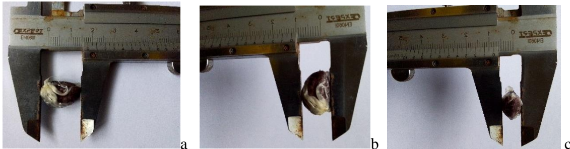
Fig. 18. Mensuration des variables de la gaine ; (a) : longueur ; (b) : largeur ; (c) : épaisseur
