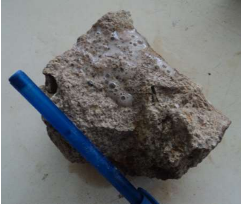
Figure 10. Réaction effervescente des grès grossiers à l'acide chlorhydrique
