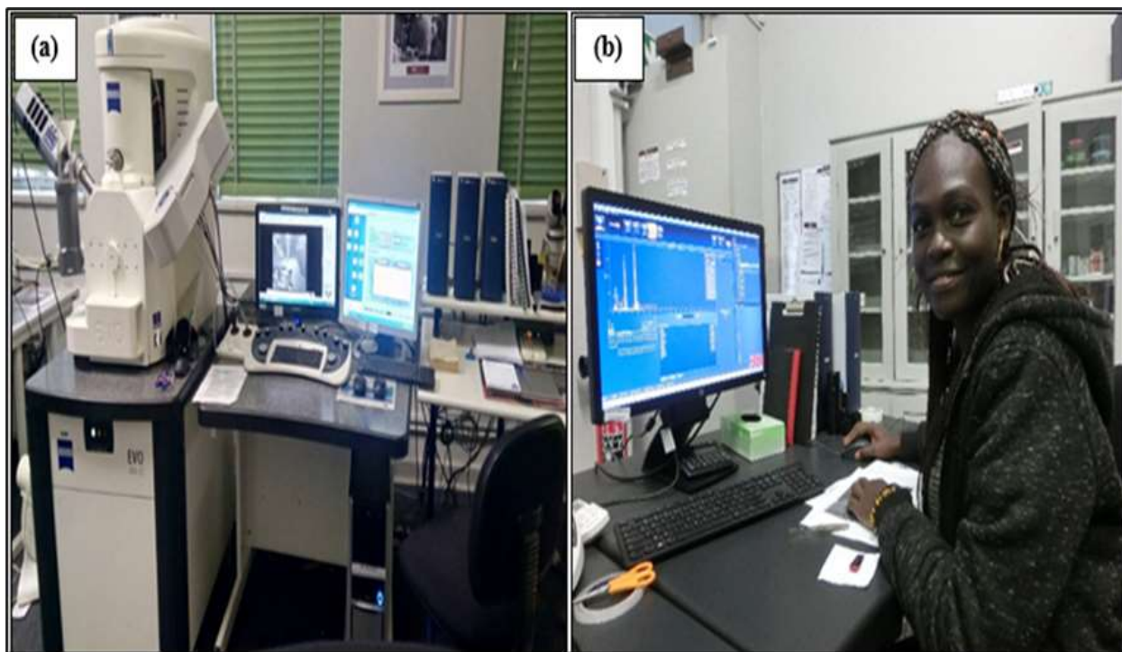
Figure 9 : Microscope électronique à balayage avec spectromètre dispersif en énergie et en longueur d'onde du CAF-US.
