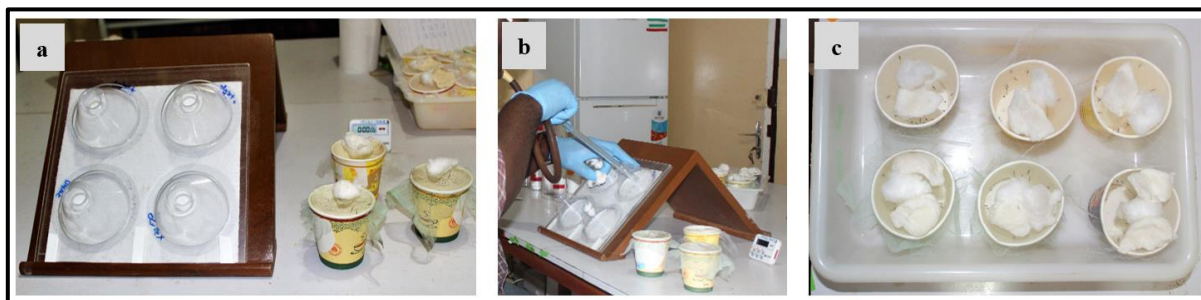
Figure 10 : Déroulement d'un test d'efficacité des moustiquaires à l'aide des cônes
