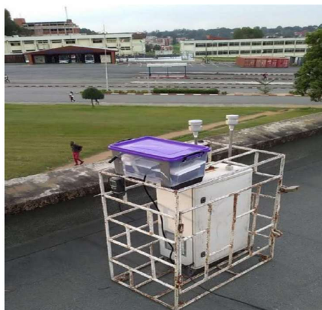
Figure 21 : Instrument de collecte de PM à l'Université Félix Houphouët-Boigny (Cocody).
