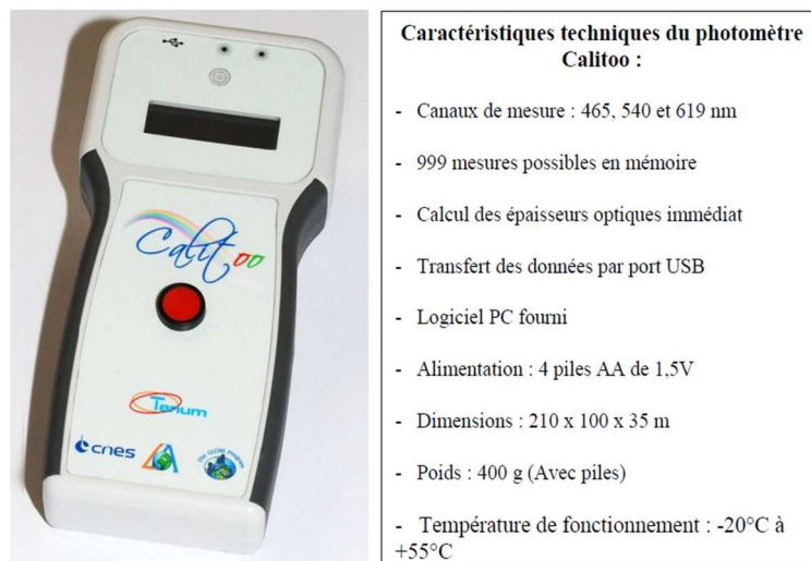
Figure 18 : Photomètre portable CALITOO et ses caractéristiques techniques
