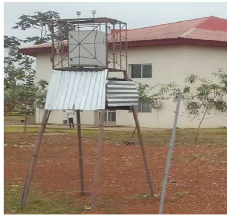
Figure 19 : Instrument de collecte de PM à l'Université Péléforo Gon Coulibaly de Korhogo.
