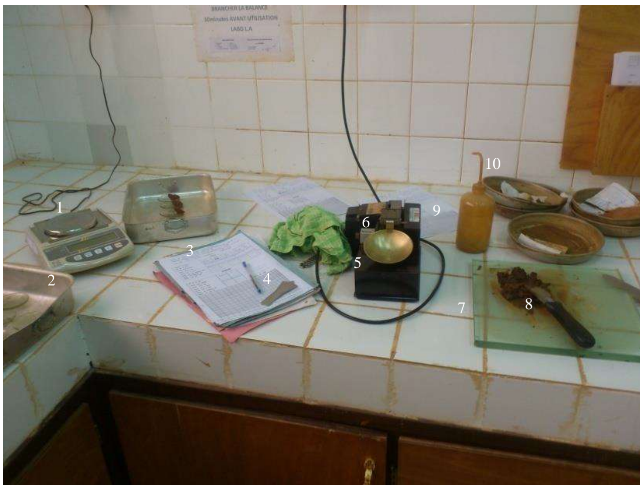
1: balance; 2: gamelle; 3: fiche de collecte de données; 4: outil à rainure; 5: base pesante; 6: coupelle lisse; 7: plaque; 8: spatule; 9: pissette; 10: assiettes Figure 10: Matériels de détermination des limites d'Atterberg.
