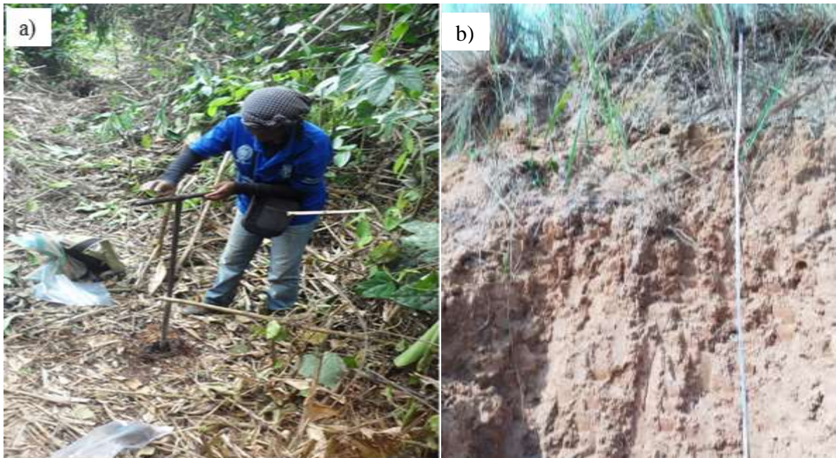
Figure 9: Prélèvement des matériaux: a) sondage à la tarière manuelle, b) sondage à l'aide d'une fosse.
