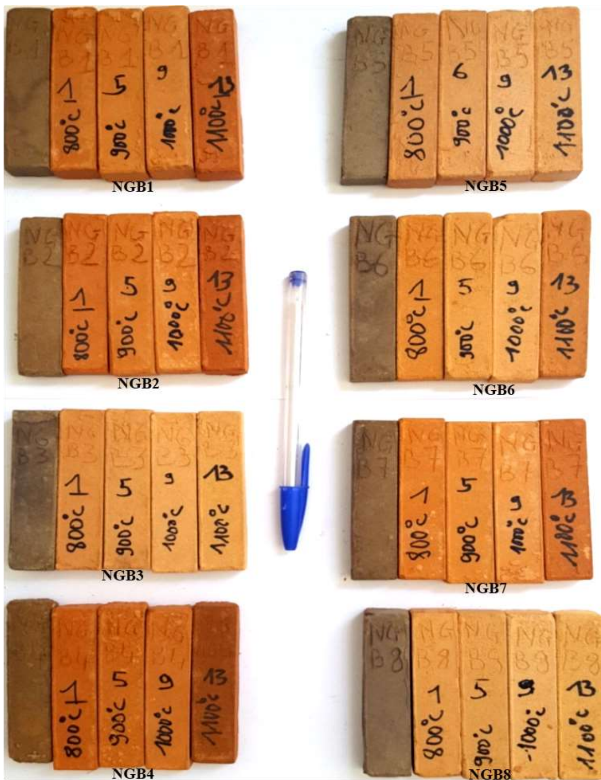
Figure 40: Photographies des éprouvettes des matériaux de Ngat-Carrière.
