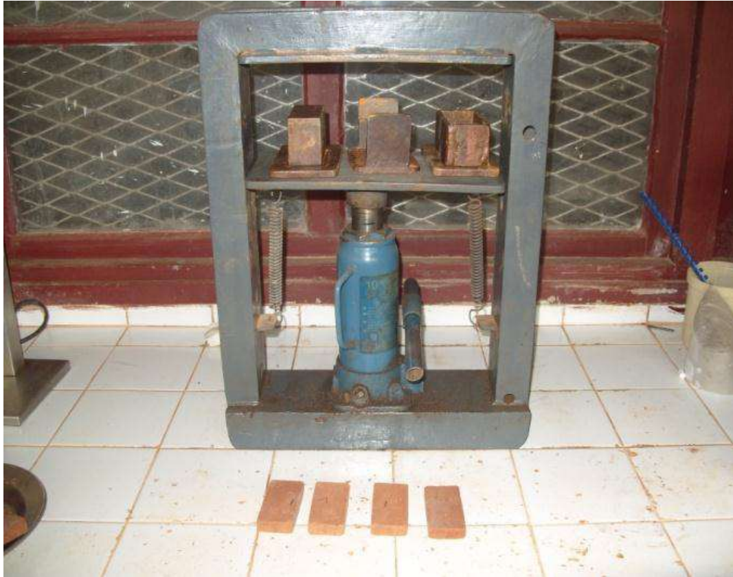
Figure 11: Presse hydraulique de laboratoire (MIPROMALO).
