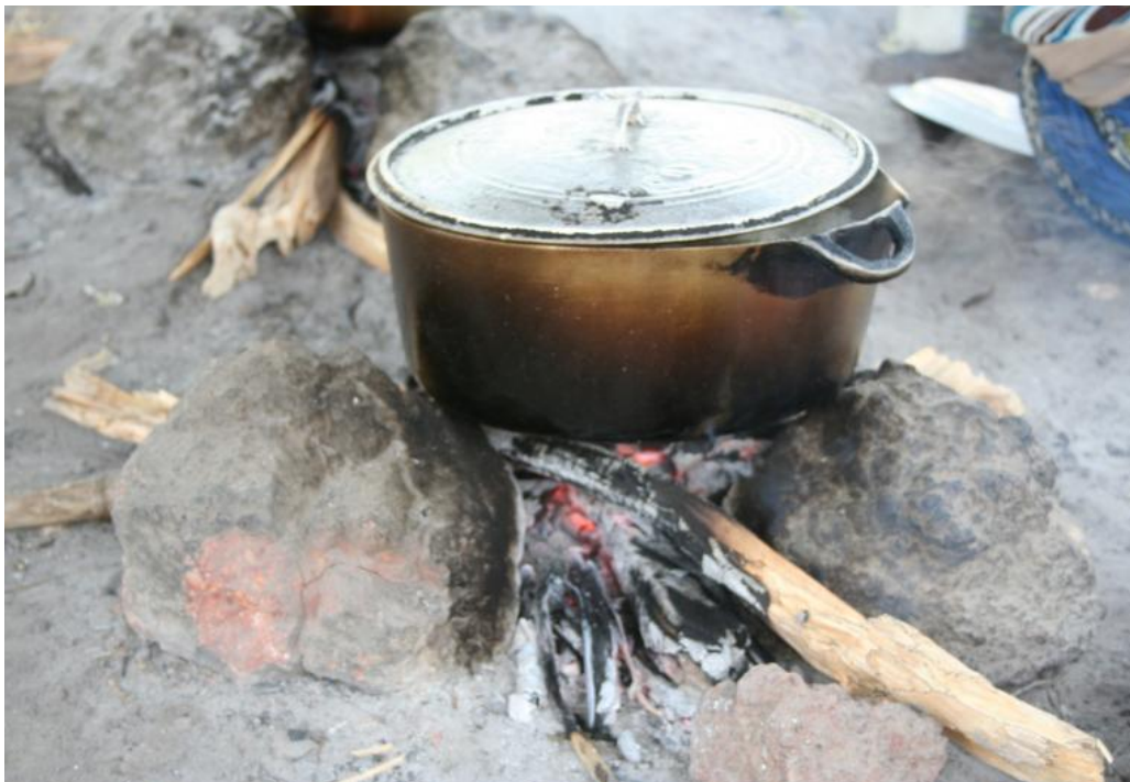
FIGURE 1.11 – Foyer traditionnel, ouvert trois pierres. [116]
