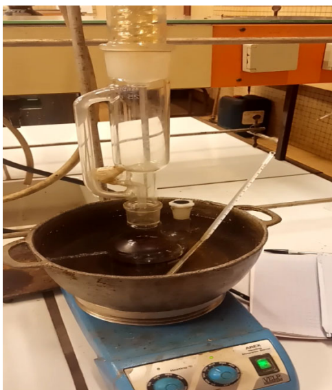
Figure 26: Dispositif expérimental de la réaction de transestérification
