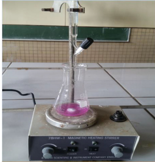
Figure 28 : Dispositif expérimental de détermination de l'indice d'acidité
