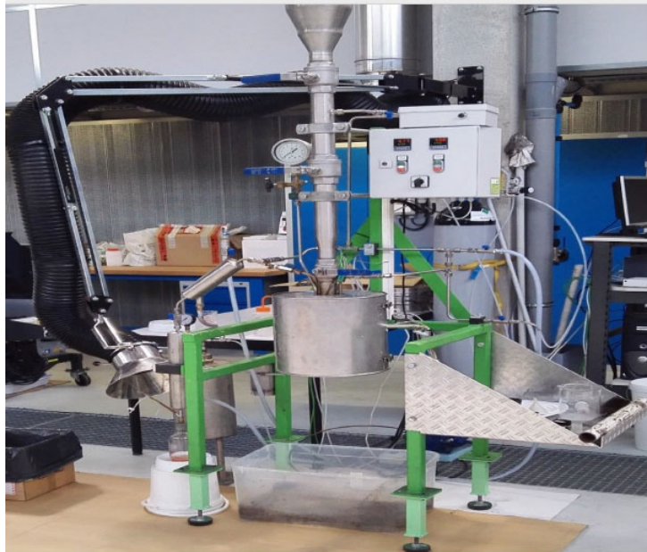
Figure 30: Dispositif expérimental de pyrolyse
