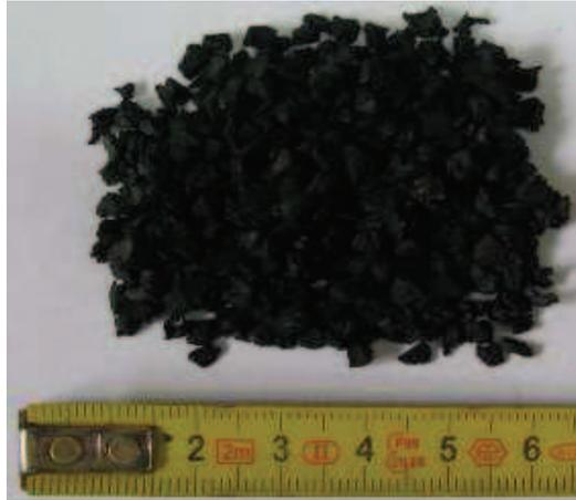
**Figure 6:** Granulats en caoutchouc de classe (0/4) mm utilisés (Ho, 2010)
