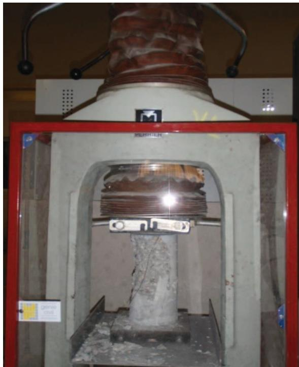
**Figure 22:** Béton soumis à une contrainte
