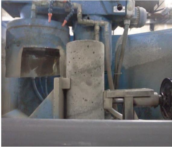
**Figure 20:** Rectification avec une meule diamantée
