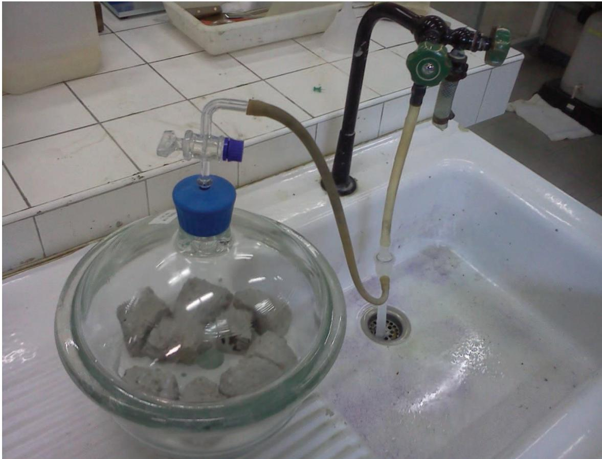
**Figure 31:** Dispositif expérimental pour la saturation sous vide
