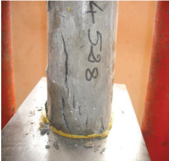
Béton de pneu usagé + Graviers
