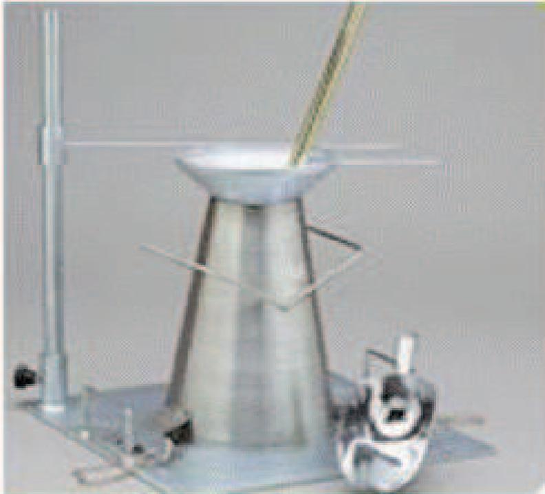
**Figure 19:** Dispositif de mesure de l'affaissement
