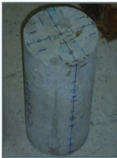
**Figure 30:** Positions des points de mesures ultrasonores
