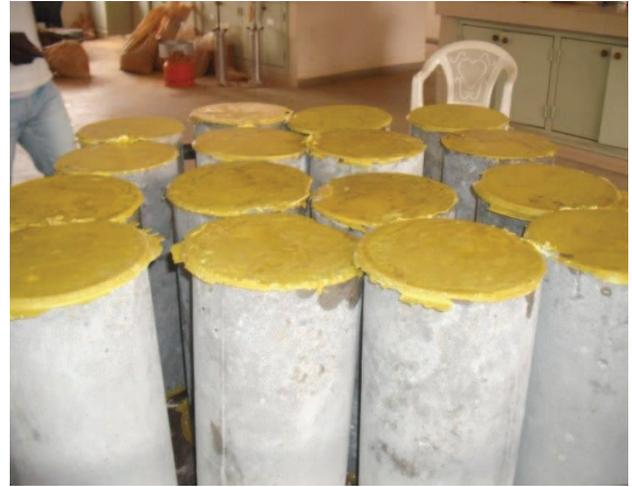
**Figure 21:** Rectification avec du soufre
