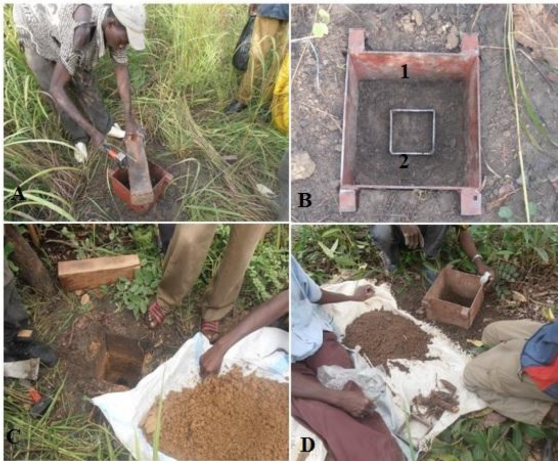
Photo 2: Procédure d'extraction des racines à Tiogo et à Laba au Burkina Faso, Afrique de l'ouest. (A)= Fixation du matériel de dimensions connues. (B)= Matériels utilisés pour l'échantillonnage. B1 = Coffret métallique (25×25×50) utilisé pour l'extraction des monolithes. B2 = Petit coffret métallique (10×10×5 cm) utilisé à chaque profondeur du sol pour prélever l'échantillon pour le lavage au Laboratoire. C et D= sols issus de blocs de terres prélevés et tris manuel des racines
