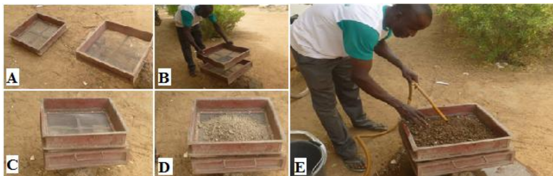
Photo 3: Dispositif de lavage du sol pour la séparation des racines fines. A= les deux pièces du dispositif, B & C=Assemblage vertical des deux pièces, D= Mise en place de l'échantillon de sol et E= lavage.
