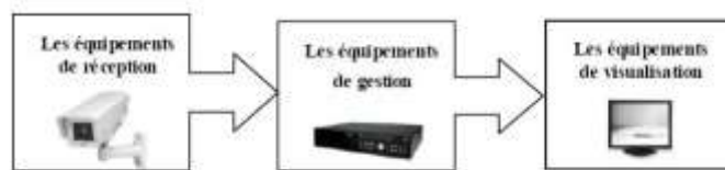
Photo n°6 : Schéma de traitement d'image par vidéosurveillance
