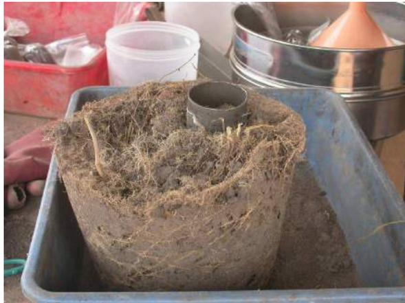
Figure 18 : Prélèvement d'un cylindre de sol pour la détermination des classes d'agrégats
