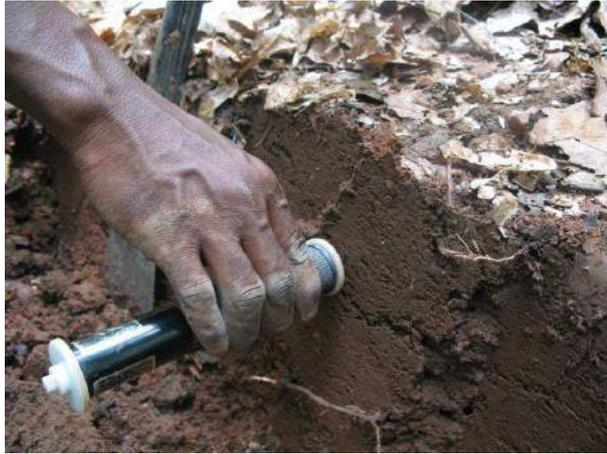
Figure 11 : Mesure de la résistance à la pénétration horizontale du sol
