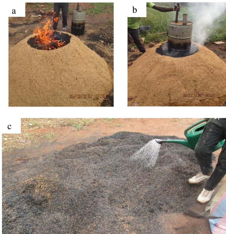
Figure 10 : Etapes de carbonisation des résidus agroindustriels : Mise en flammes (a), Combustion (b) et Refroidissement (c)
