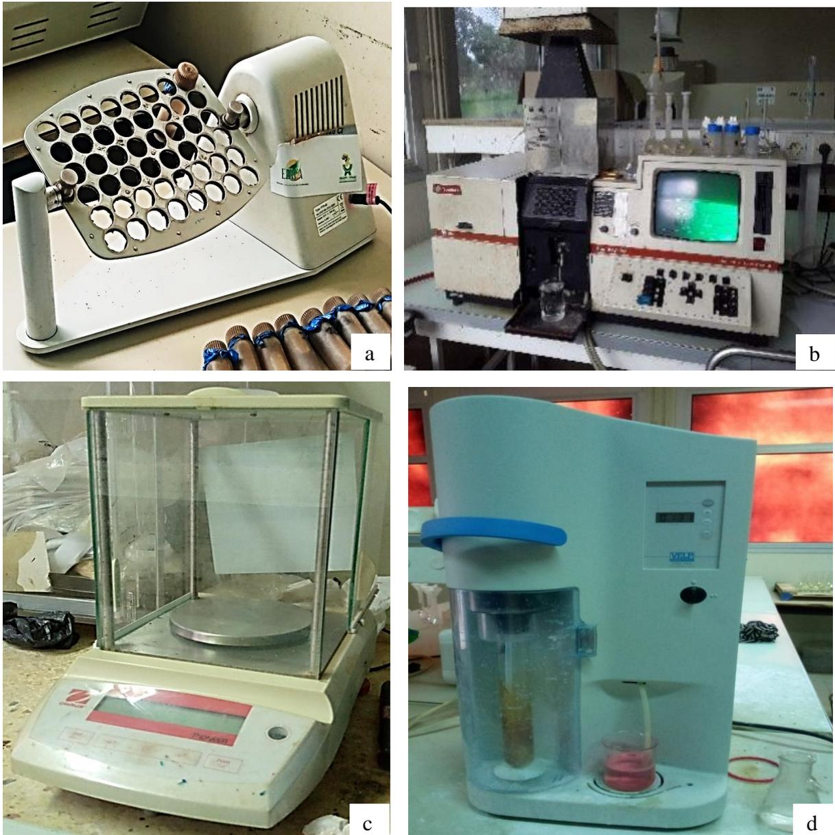
Figure 9 : Quelques appareils de laboratoire : Agitateur rotatif-vibratile (a), Spectrophotomètre d'absorption atomique (b), Balance de pesée (c) et distillateur (d)
