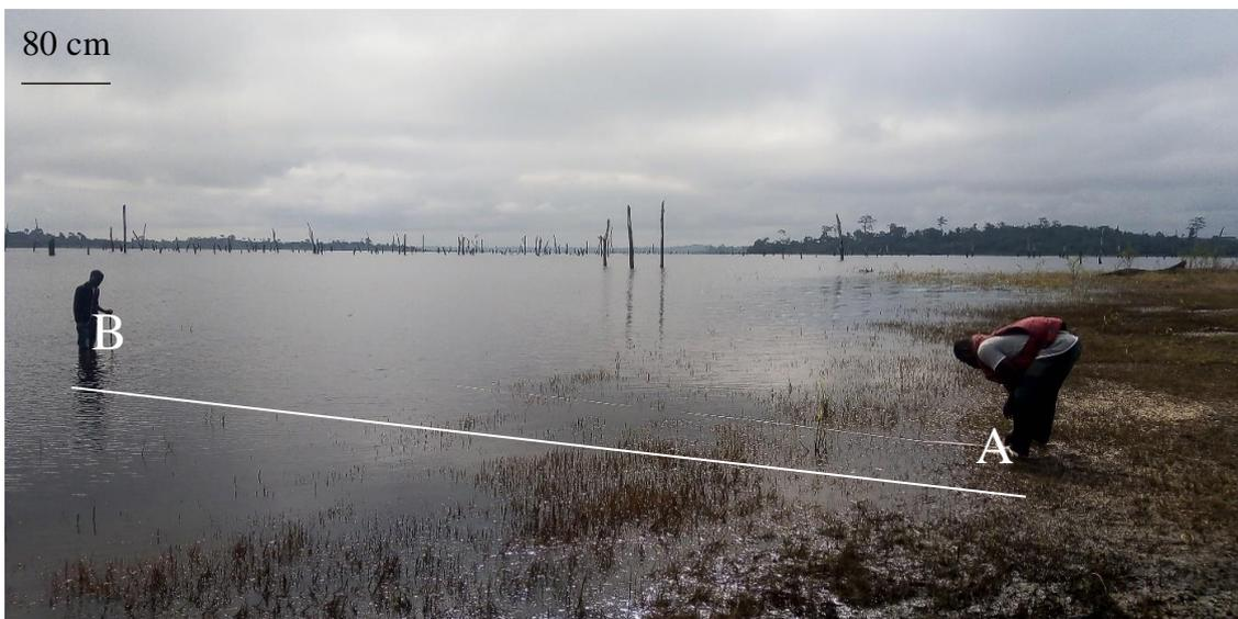
Figure 17 : Mesure de la pente de la berge immergée de la zone littorale du lac de Buyo (Côte d'Ivoire) de janvier à décembre 2020 : AB = distance utilisée pour calculer la pente.
