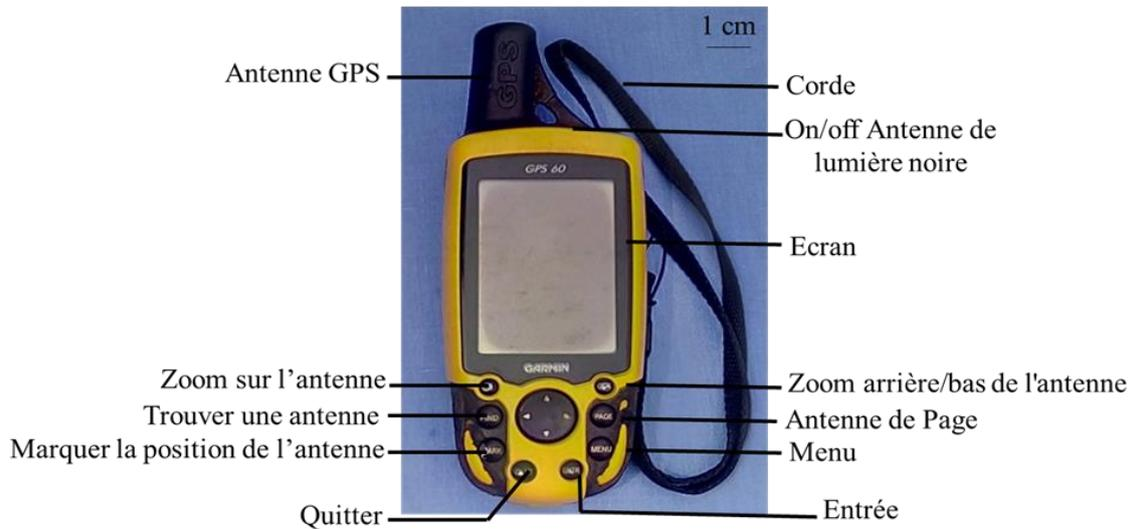
Figure 7 : GPS de type GARMIN 60 utilisé pour la prise des coordonnées géographiques des différentes stations d'échantillonnage de la zone littorale du lac de Buyo (Côte d'Ivoire) de janvier à décembre 2020.
