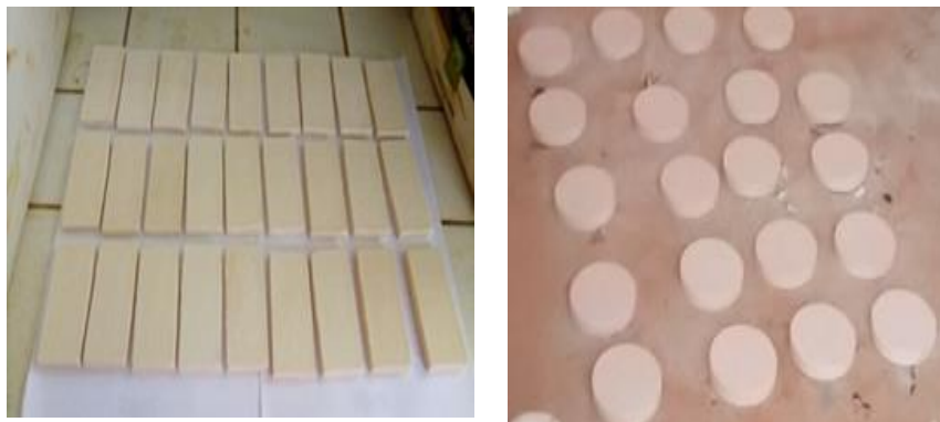
Figure 40 : Aspect physique des membranes
