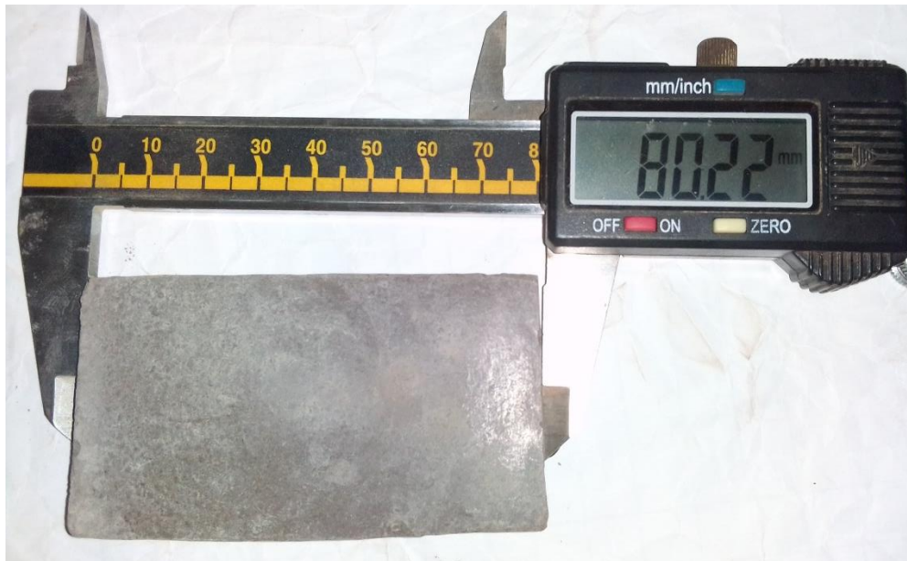
Figure 30 : Mesure des paramètres de l'éprouvette à l'aide du pied à coulisse électronique.
