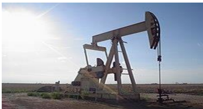
Photo 4 : Chevalet de pompage sur un puits de pétrole
