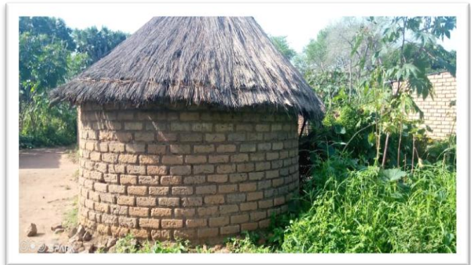
Photo 37: Case ronde en brique cuite
