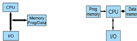
Figure 27 – Architecture Von Neumann (à gauche), architecture Harvard (à droite) [90]
