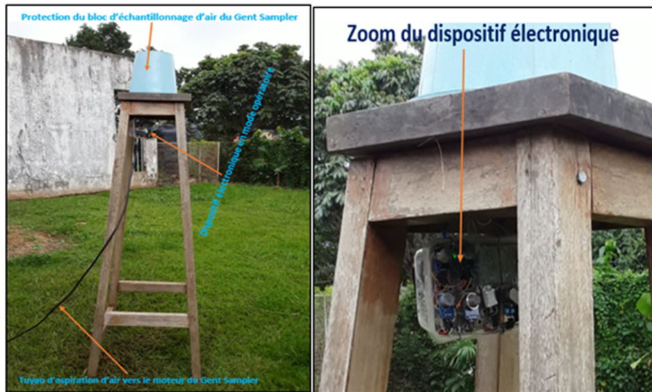
Figure 69 – Systèmes de mesure installés sur le terrain et Zoom du dispositif proposé
