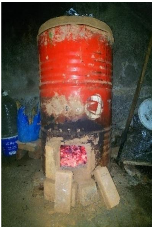
Ph. 46 : Four traditionnel pour cuisson céramique Source : L. Yougang le 19février 2023 à 13h
