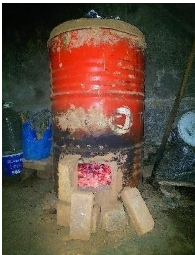
Ph. 26 : Four traditionnel au charbon : Etape de transfert au biscuit
