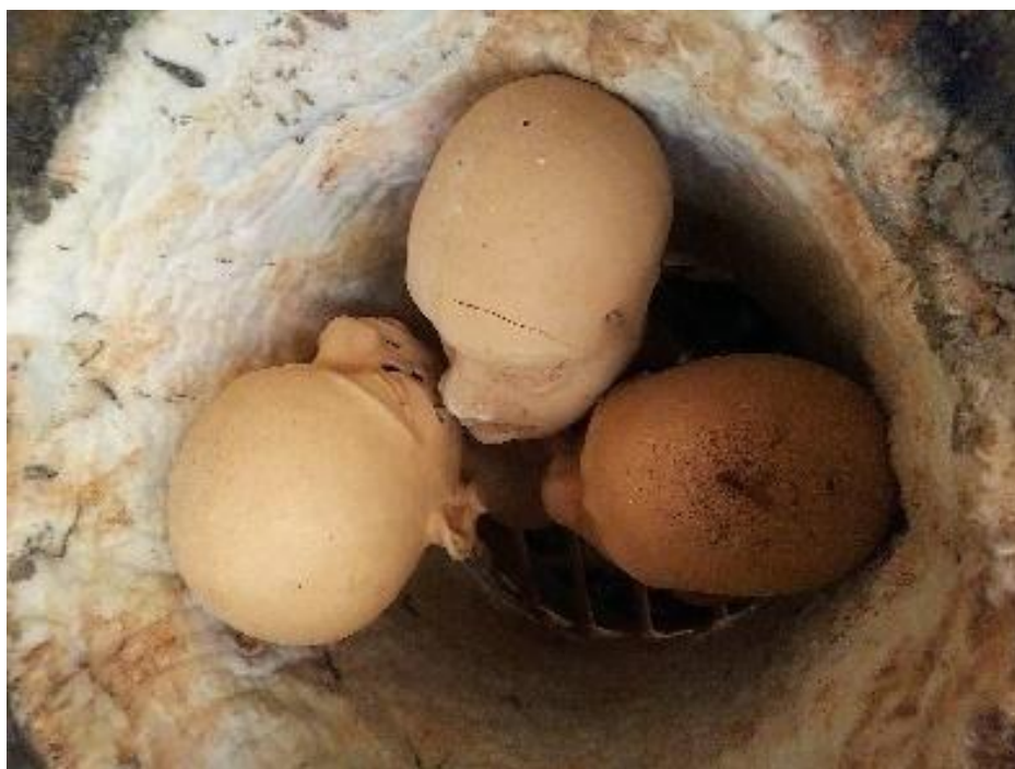
Ph. 27 : enfournement des bustes dans le four pour cuisson.
