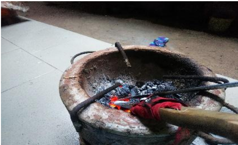
Ph. 10 : Four, source de chaleur et couteau à chauffer
