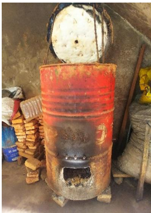
Ph 47 : Four traditionnel pour cuisson céramique Source : L. Yougang le 19février 2023 à 13h
