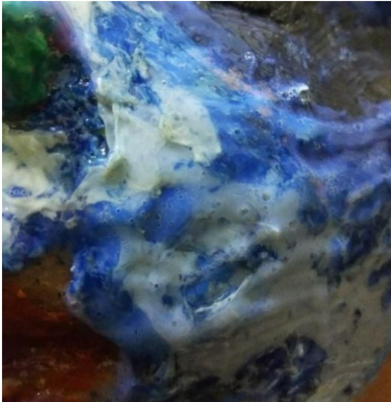
Ph. 29 : Fonte par adhésion au polyamide
