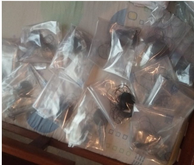
FIGURE 2.3.3 – Emballages en polystyrène de petites dimensions pour le conditionnement des dispositifs de mesure du radon
