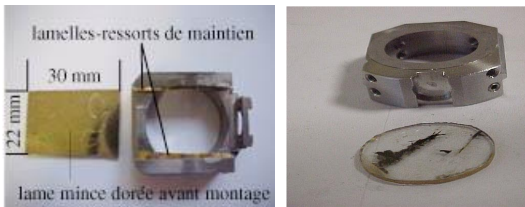
Figure 8. Préparation des échantillons pour la sonde ionique à partir des lames minces de roches
