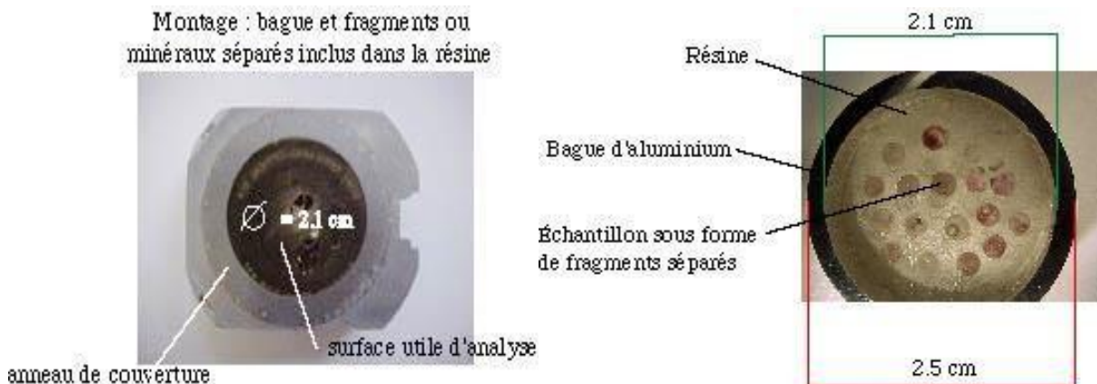
Figure 9. Montage des minéraux séparés pour l'analyse à la sonde ionique.
