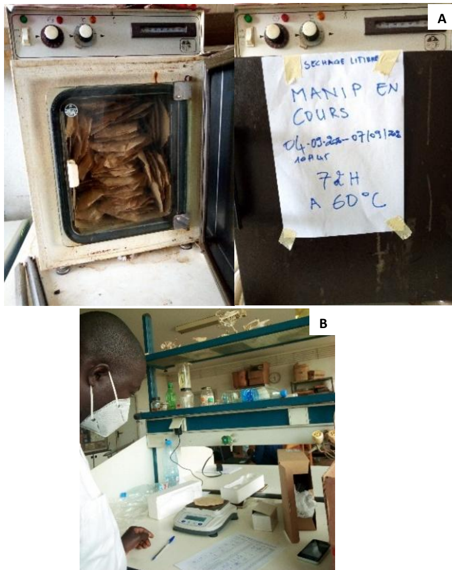
Figure 20: Dispositifs de séchage (A) et de pesage (B) de la litière au laboratoire après exposition dans les cours d'eau. L'image A montre le séchage à l'étuve à 60°C et l'image B, le pesage après refroidissement sur la balance électronique
