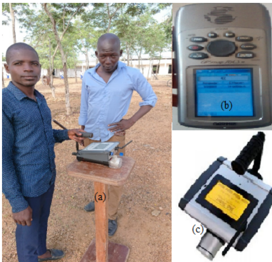
Figure 2.5 – Mesure de la radioactivité par la spectrométrie \gamma in-situ . Il s'agit : du dispositif de mesure en (a), du spectromètre à scintillation NaI(Tl) 3 \times 3 pouces avec le préamplificateur et l'amplificateur appelé NucScout en (c) et du GPS pour mesurer les coordonnées géographiques du point de mesure en (b).
