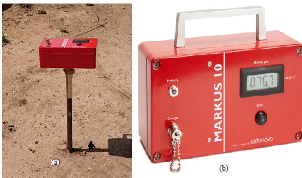
Figure 2.6 – Dispositif de mesure à l'aide du détecteur en (a) et détecteur de type Markus 10 en (b) utilisé pour la mesure des concentrations de ^{222}\text{Rn} dans le sol.
