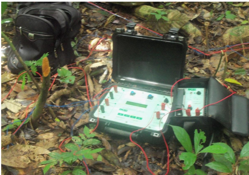
Figure 6 : Photographie du résistivimètre utilisé pour l'acquisition des données.
