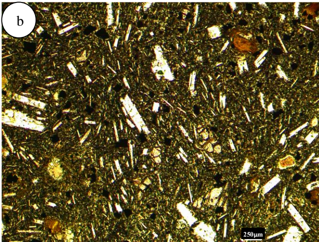
Figure III.10. Macrophotographie (a) et microphotographies des granulats basaltiques en lumière polarisé non analysée (b) et en lumière polarisée et analysée (c) ; Pl: Plagioclases ; Ol: Olivine ; CPx : Clinopyroxene
