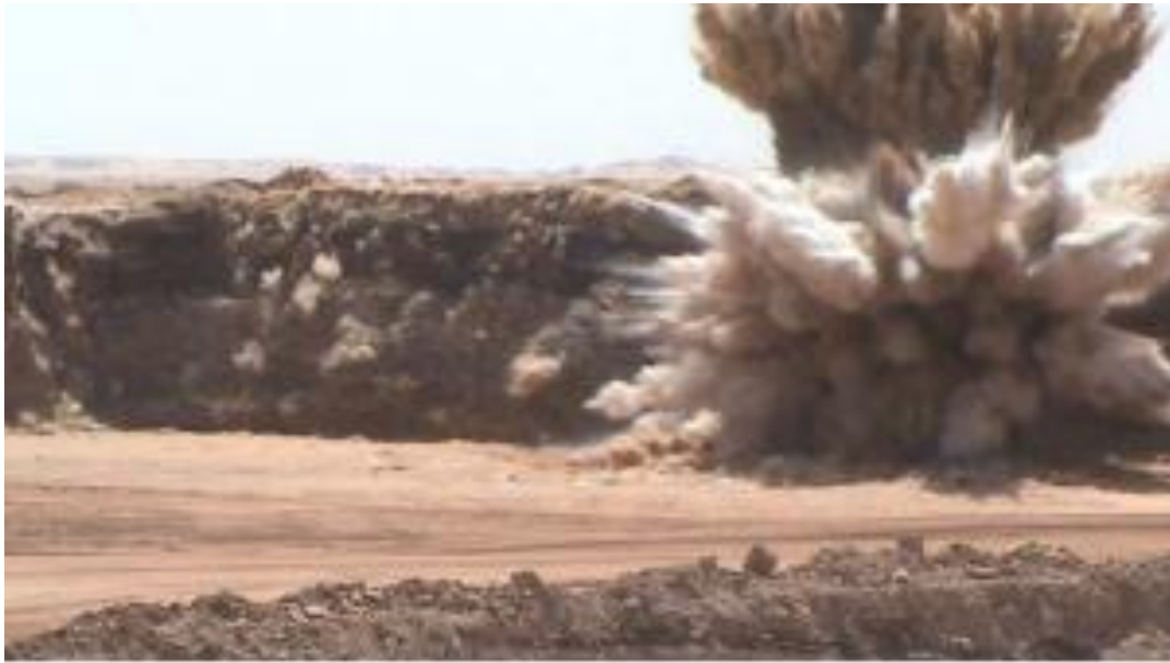
Figure II-4. Séquence de mise à feu (De Lile, 2012).
