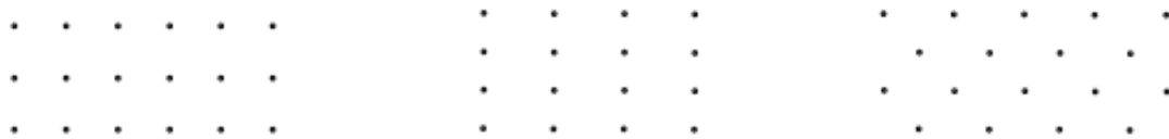
Figure II-8. Principaux types de maille utilisée lors des tirs des mines (Coulombe, 2011).
