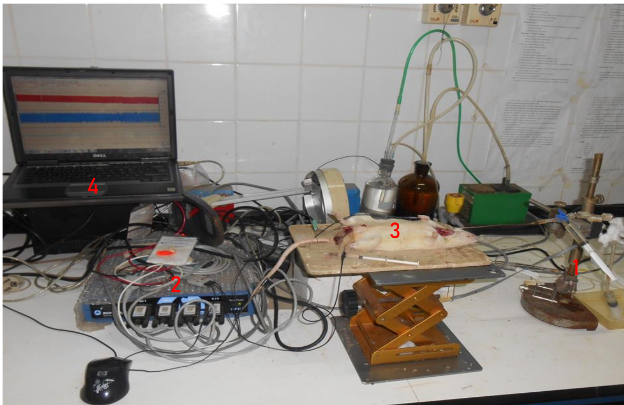
Figure 8 : Dispositif d'enregistrement de la pression artérielle et de la fréquence cardiaque (CHINTE Ramatou, Juin 2018). 1 : transducteur ; 2 : enregistreur Biopac MP 35 ; 3 : rat ; 4 : ordinateur
