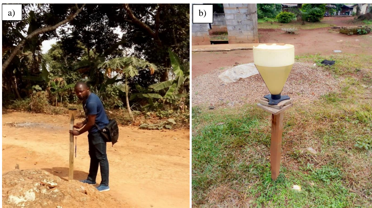
Figure 16 : Pluviomètres installés à : a) Nsimalen ; b) Etoud ( Cliché Nsangou, 2019 )
