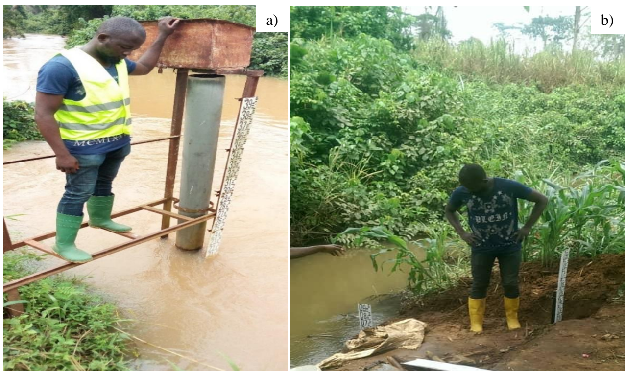
Figure 18 : Stations hydrométriques installées et/ou réhabilitées dans le BVAM : a) station de Nsimalen ; b) station d'Etoud. (Cliché Nsangou, 2019)
