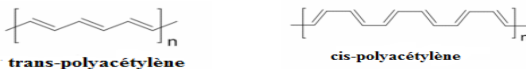
Figure 2. Quelques exemples de polymères conjugués : le trans-poly acétylène et le cis-poly acétylène [15].
