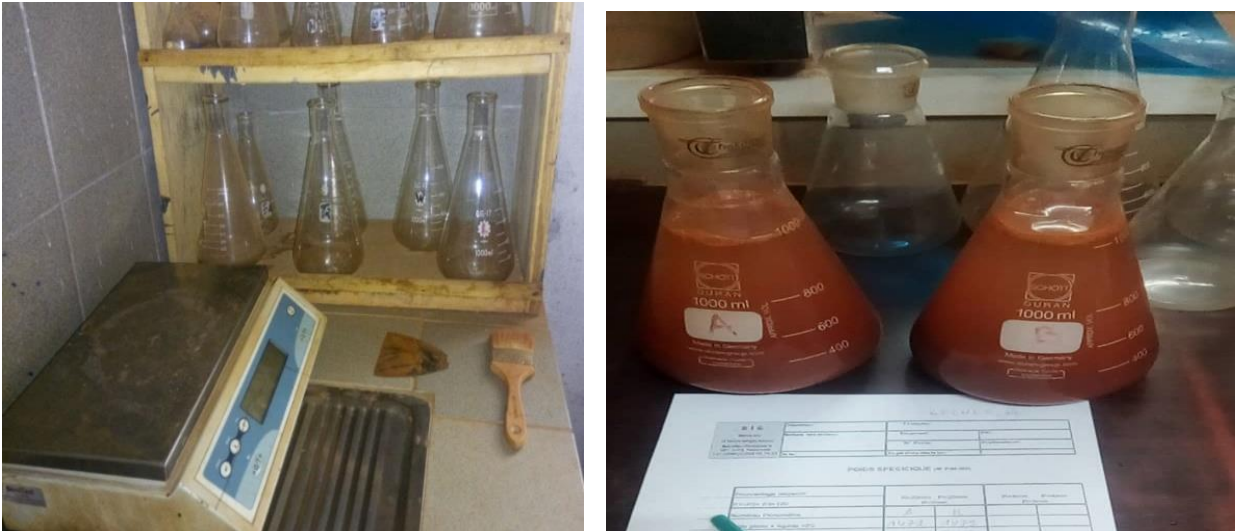
Figure II-14. Réalisation de l'essai de poids volumique.
