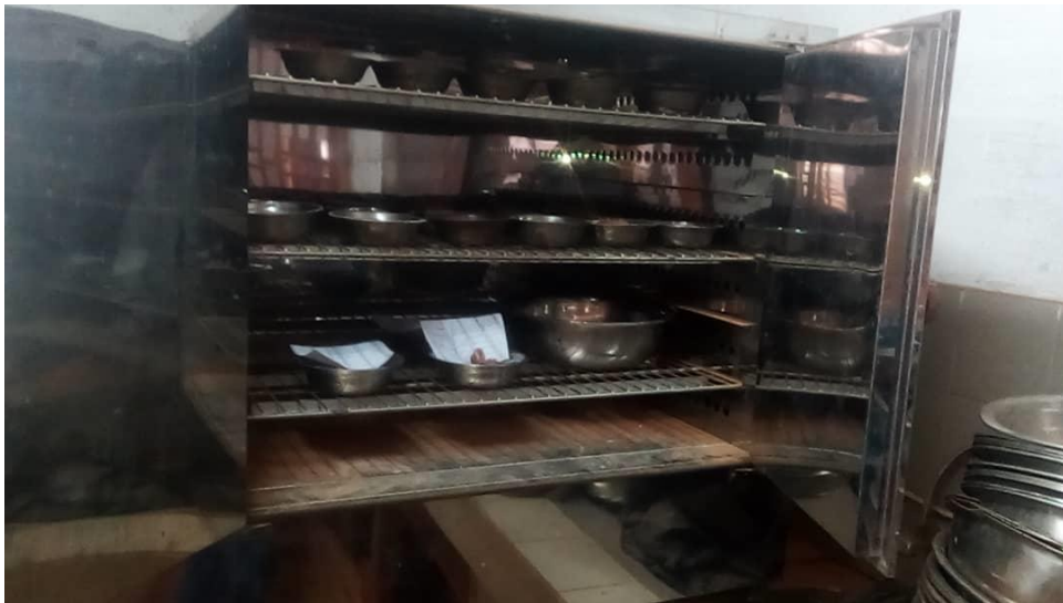
Figure II-13. Une étuve permettant de sécher les échantillons présentes dans les tares
