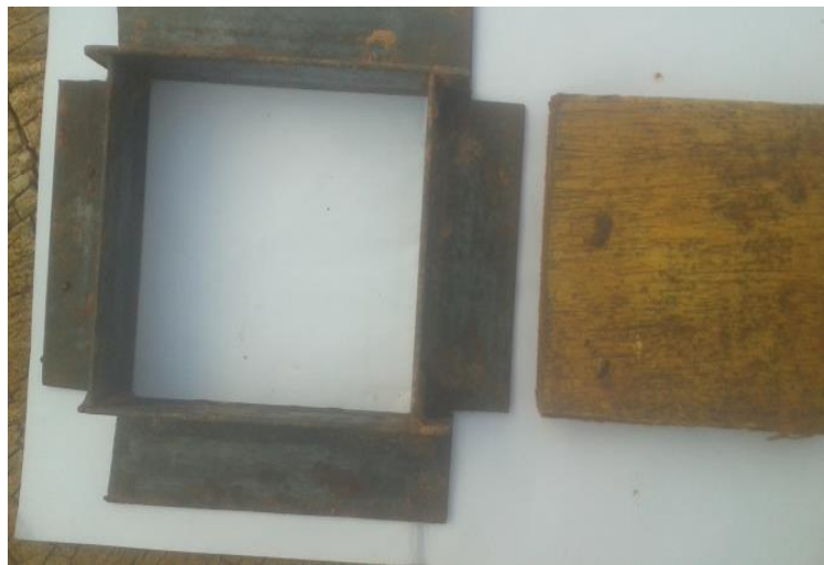
Figure II-8. Moule en acier Ep5 de dimension 10 cm x 10 cm x 5 cm
