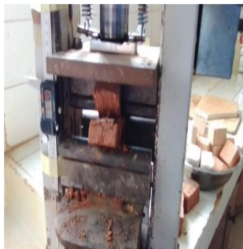
Figure II-16. Eprouvette d'échantillon soumise à l'essai de flexion
