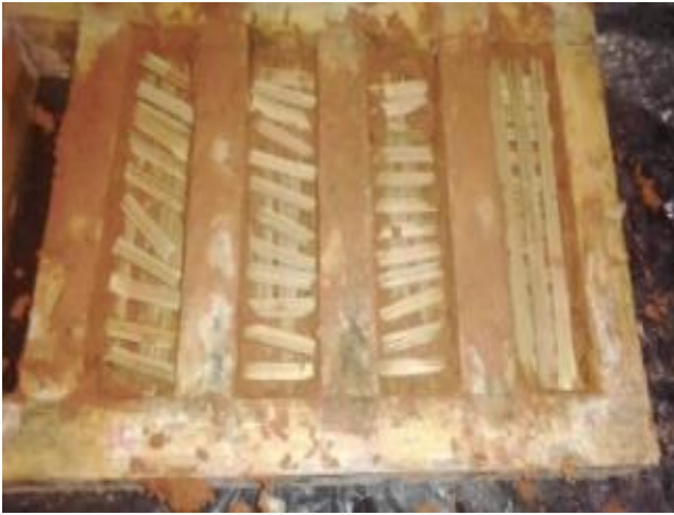
Figure II-18. Eprouvettes de dimension 4x4x16cm pour l'essai de flexion
