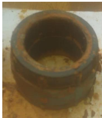
Figure II-10. Moule cylindrique pour la confection des éprouvettes de poto-poto pour la caractérisation acoustique
