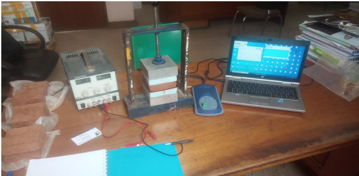
Figure II-34. Dispositif expérimental plan chaud asymétrique
