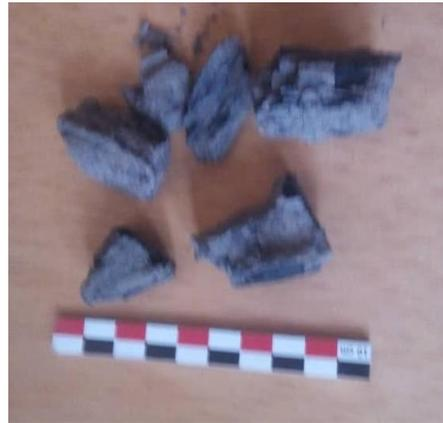
**Photo n° 11. Scories formées au fond du fourneau minerais et scories de fer extraites à l'orifice (fourneau N°1)**
