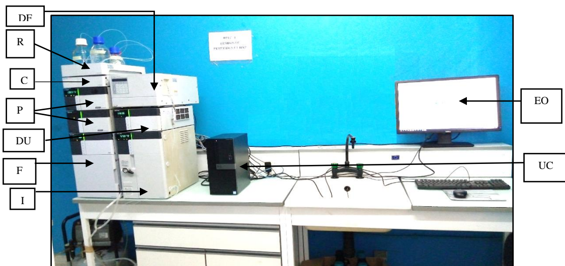
Figure 9 : Chaîne de CLHP (Photo prise par Djédjé)
