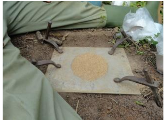
b. Remplissage à l'excès puis rasage de surface du sol
