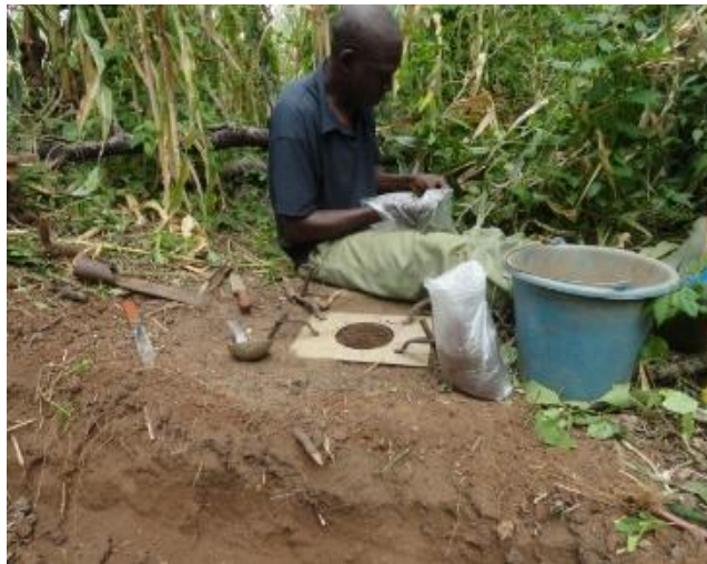
c. Récupération de l'excédent de sable marin
