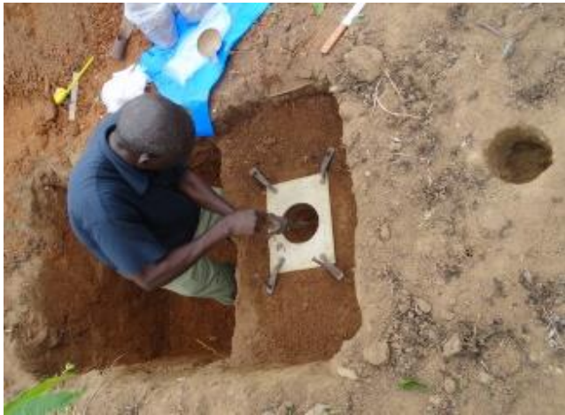
a. Fixation de la plaque métallique au sol et prélèvement de sol
