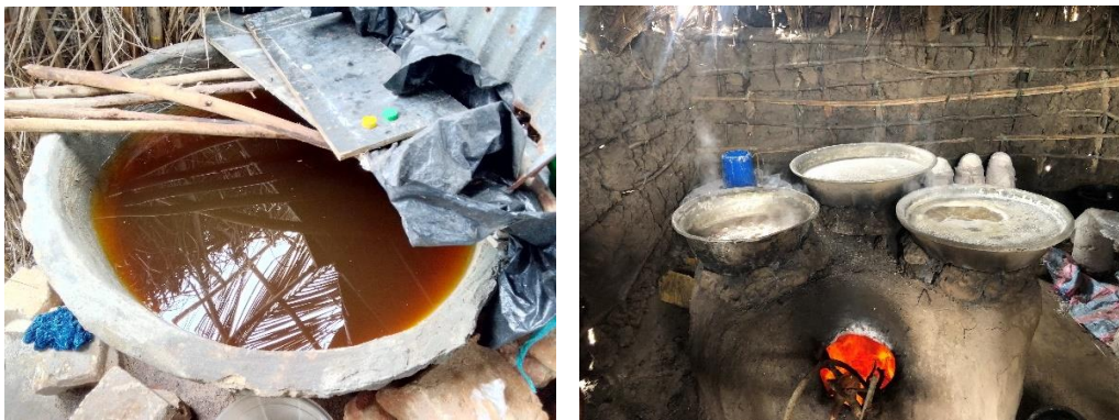
Photo 7 Stockage de la saumure (a) et cuisson (b)
