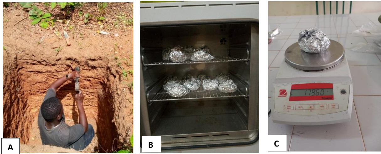
Figure 5: Détermination de la densité apparente du sol
