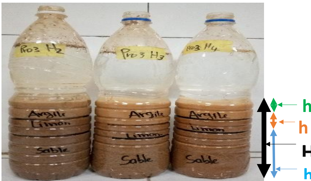
Figure 4 : test de granulométrie
